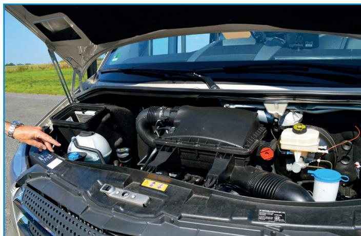
au centre, le moteur et l'ensemble d'injection et filtre, le bouton rouge pour couper le courant et enfin le réservoir de liquide de freinage et celui du lave-glace.
