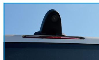
Le Mercedes Travel testé est équipé d'une caméra de recul (placée au-dessus du troisième feu stop).
