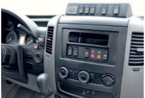
**Citystar:** Zwei Türen erfordern mehr Funktionen. Die bustypischen Schalter an der Mittelkonsole sind in zwei Reihen übersichtlich aufgeteilt.
