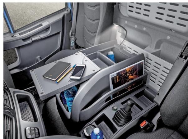
🔌🔌 Livré en option, le coffre central permet de dissimuler du matériel de valeur et participe à l'évolution des habitacles vers le « bureau roulant ». Il comprend deux prises USB. On trouve par ailleurs deux autres prises USB en haut de la console centrale. Il est ainsi facile d'alimenter GPS, téléphone ou tablettes.
