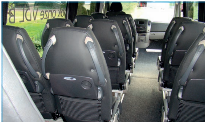
Photos ci-dessus et ci-dessous : le MidEuro de VDL est aménagé avec un coffre à bagages de 2,56 m 3 avec séparation et éclairage en partie supérieure et sur les côtés, ainsi que des sièges inclinables avec poignées, tablettes, filets...
