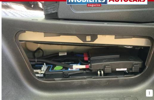
**1** La batterie est placée dans l'embranchement de la porte conducteur. Les connexions sont accessibles par une trappe.
