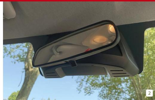
**2** Le gros bloc de caméras pour les assistances à la conduite est placé en haut du parebrise derrière le rétroviseur intérieur.
