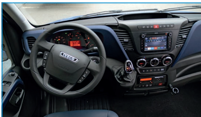
Le poste de conduite du Tourys intègre les nouveaux aménagements du Daily Euro 6 dont la boîte Hi-Matic à 8 rapports.
