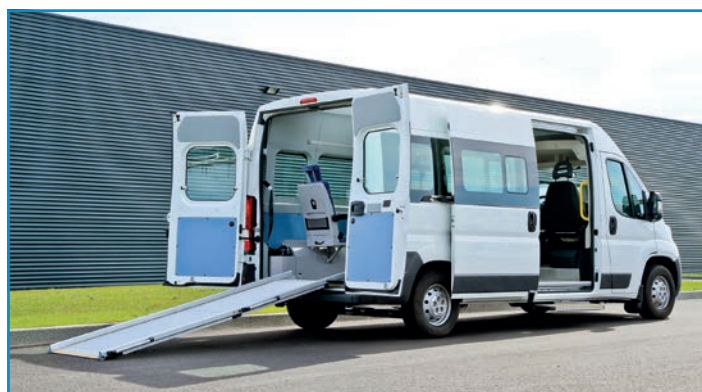
Le Modulis 50 de Dietrich Véhicules est lui destiné au transport de personnes à mobilité réduite. Il dispose de sièges totalement repliables (ci-contre) pour accueillir une ou des personnes en fauteuil roulant.
