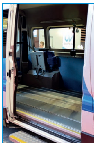
Le Modulis 50 de Dietrich Véhicules est lui destiné au transport de personnes à mobilité réduite. Il dispose de sièges totalement repliables (ci-contre) pour accueillir une ou des personnes en fauteuil roulant.
