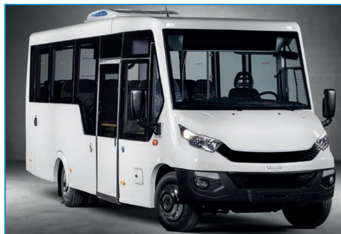
Le Mobi Low Entry de VehiXel, sur base Iveco Daily, met l'accent sur l'accessibilité grâce à une large porte et une rampe manuelle.
