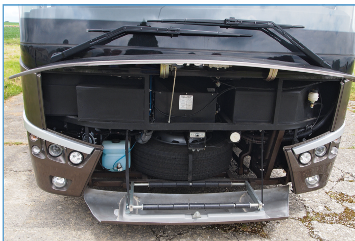
Les panneaux de la face avant s'ouvrent tous pour accéder au moteur des essuie-glaces, au liquide pour nettoyer le pare-brise et à la roue de secours.
