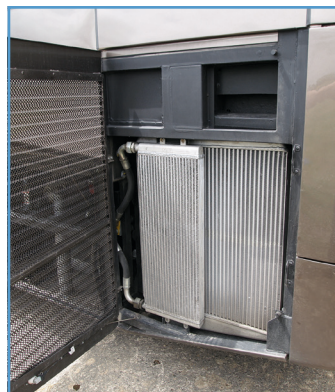
En ouvrant cette grille, on peut venir facilement à bout des saletés obstruant le radiateur.
