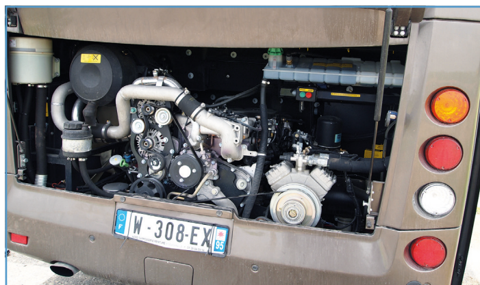
En ouvrant cette grille, on peut venir facilement à bout des saletés obstruant le radiateur.
