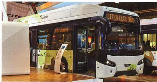
VDL, fidèle à sa vision multisolution (comme Solaris), développe une vraie gamme de VDL Citea Electric, allant du Citea SLFA de 18 à 18,75 m. Ils sont animés par des chaînes de traction Siemens ou Ziehl-Abegg. Cette offre complète le Citea Hybrid, associant moteur Diesel Cummins ISB4.5 et chaîne de traction électrique Siemens de 160 kW et 1 500 Nm de couple.
