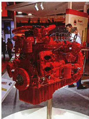
Cummins a adapté ses moteurs ISB au mode start-and-stop. Outre un renforcement des organes sensibles (démarrateur, volant moteur, coussinets et paliers, circuit de lubrification), le constructeur en a profité pour accroître les valeurs de couple et de puissance de cette famille de moteurs de plus en plus populaire.
