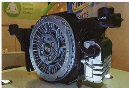
Telma met en avant le ralentisseur électromagnétique à courant de Foucault AF5, disponible en option sur Mercedes-Benz Sprinter. Déjà proposé en option usine sur l'Iveco Bus Daily, à boîte manuelle, ce dispositif de sécurité et de confort sera combinable avec la boîte automatique Hi-Matic 8 rapports dès le mois de mars 2016.
