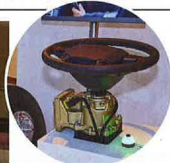
Volvo met l'accent sur le très innovant Volvo Dynamic Steering : le système corrige les effets de dérive dus à l'inclinaison de la chaussée ou à l'ornièrage. Il atténue aussi les effets des cahots sur le volant. Une option proposée sur toute la gamme série 9000, déjà bien connue sur les camions de la marque.
