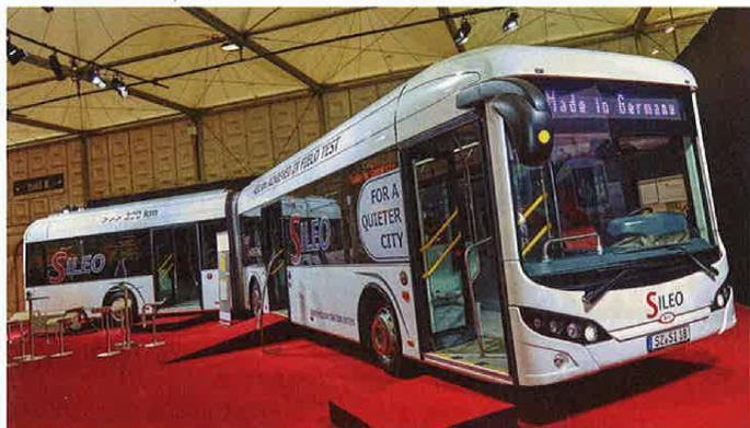
Sileo est la marque dédiée à la traction électrique pour le groupe turc Bozankaya. Ce dernier propose une charge stationnaire en dépôt (de 4 kW, charge complète en 50 heures, jusqu'à 100 kW, et charge en 2 heures suivant l'installation chez l'exploitant).
