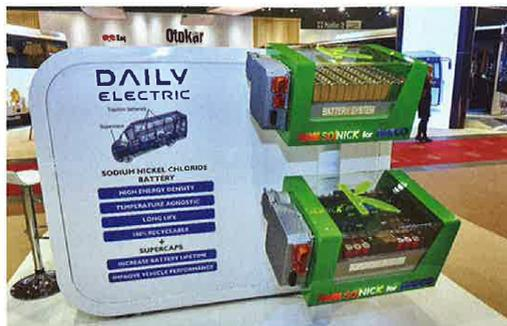
Pack de batteries sodium-nickel métal hydrures, développé par FIAMM et monté sur l'Iveco Daily Electric. Construit sur un châssis de Daily 50 C, ce modèle embarque aussi des supercondensateurs Maxwell pour les cycles de démarrage/arrêt.
