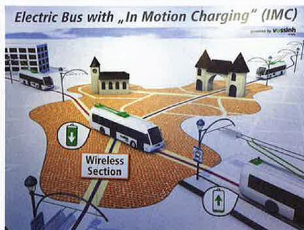
Vossloh Kiepe rappelle que ses solutions d'électrification sont ouvertes et compatibles avec différentes architectures, allant de l'autonomie pure (charge filaire ou à induction), à la charge par pantographe, sans oublier le trolleybus !
