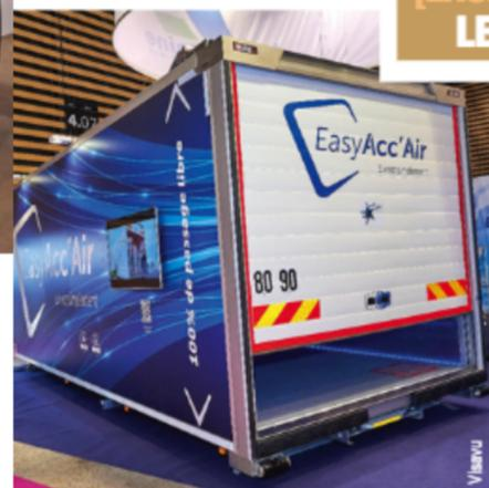
EasyAcc'Air, la solution proposée par Lecapitaine, est une nouvelle porte sectionnelle, utilisée pour le transport et la distribution urbaine de marchandises sous température dirigée. Elle combine les avantages d'une porte battante et d'un rideau. Sa cinématique de fermeture invisible brevetée n'impacte pas la hauteur hors tout du véhicule et permet un passage 100 % libre de chargement. L'isolation est assurée par un système d'étanchéité gonflable, lui aussi breveté.
