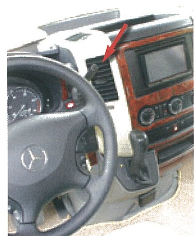
Le ralentisseur Telma est commandé par un levier installé au tableau de bord.
