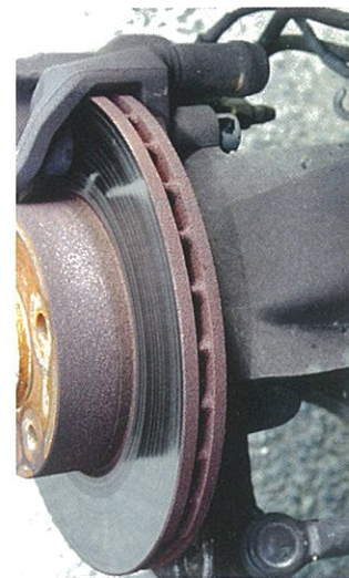
Les disques adoptent une conception ventilée pour optimiser le refroidissement.
