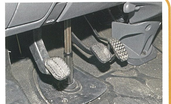
La pédale de frein (celle du milieu !) est un bon outil pour estimer les signes de faiblesse du circuit de freinage.
