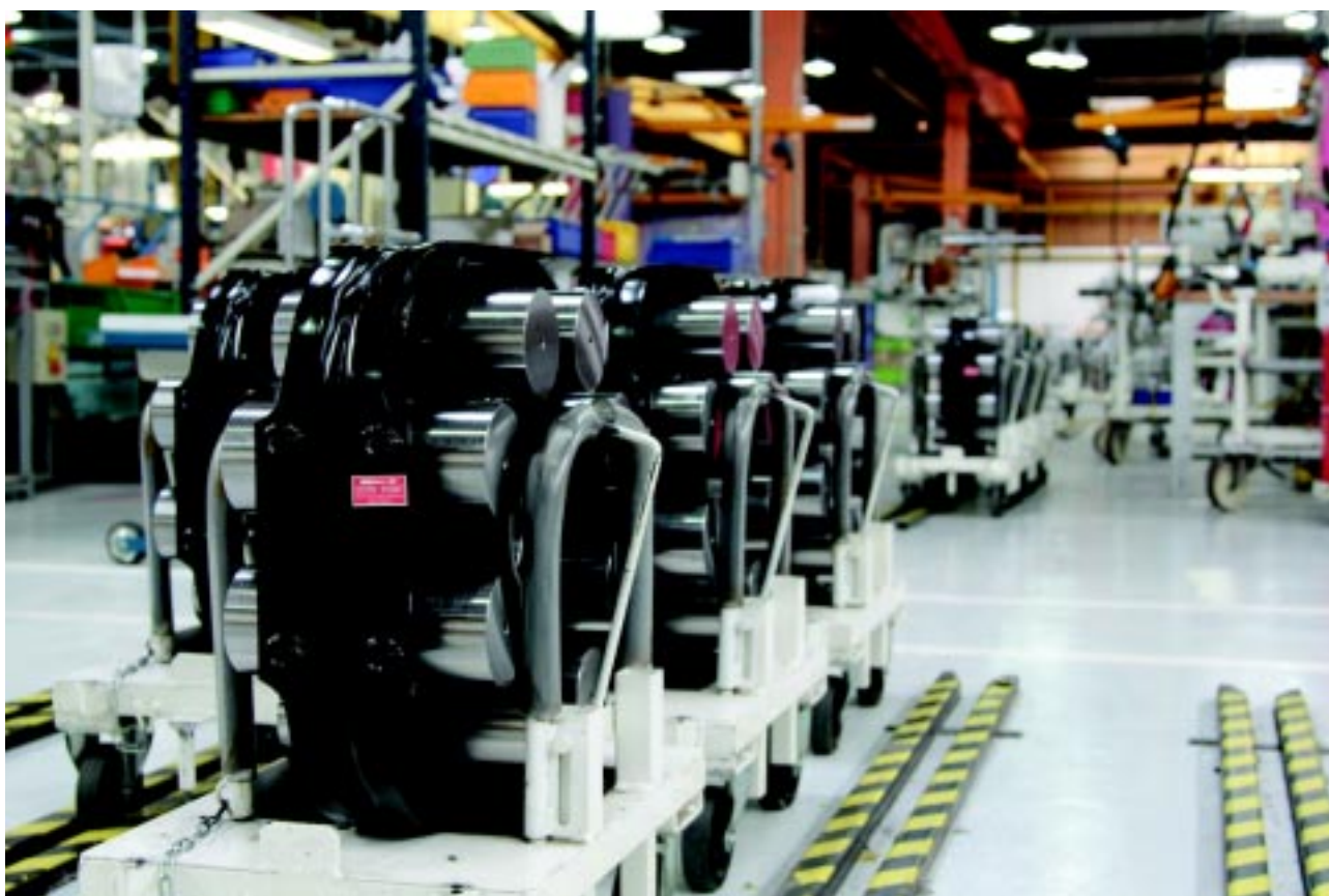
Los frenos de inducción Telma en la línea de fabricación en la fábrica de Saint-Ouen, Francia, que visitamos en fecha reciente.
