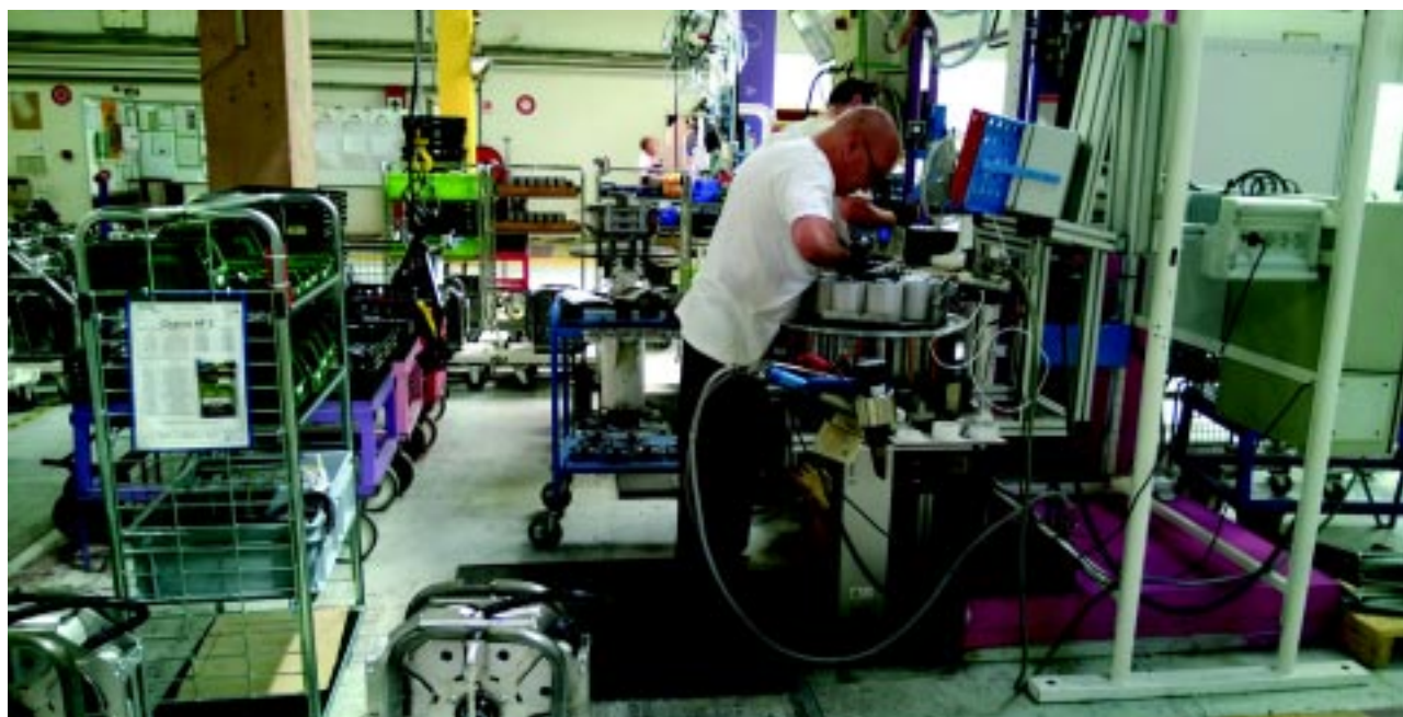
Personal técnico altamente calificado procede al armado de un freno de inducción Telma en la fábrica de Saint-Ouen.
