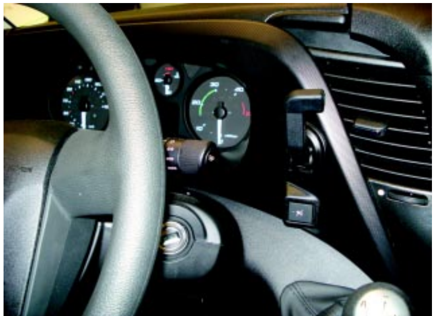
La palanca de comando del freno Telma en el tablero de instrumentos del Iveco Daily.
