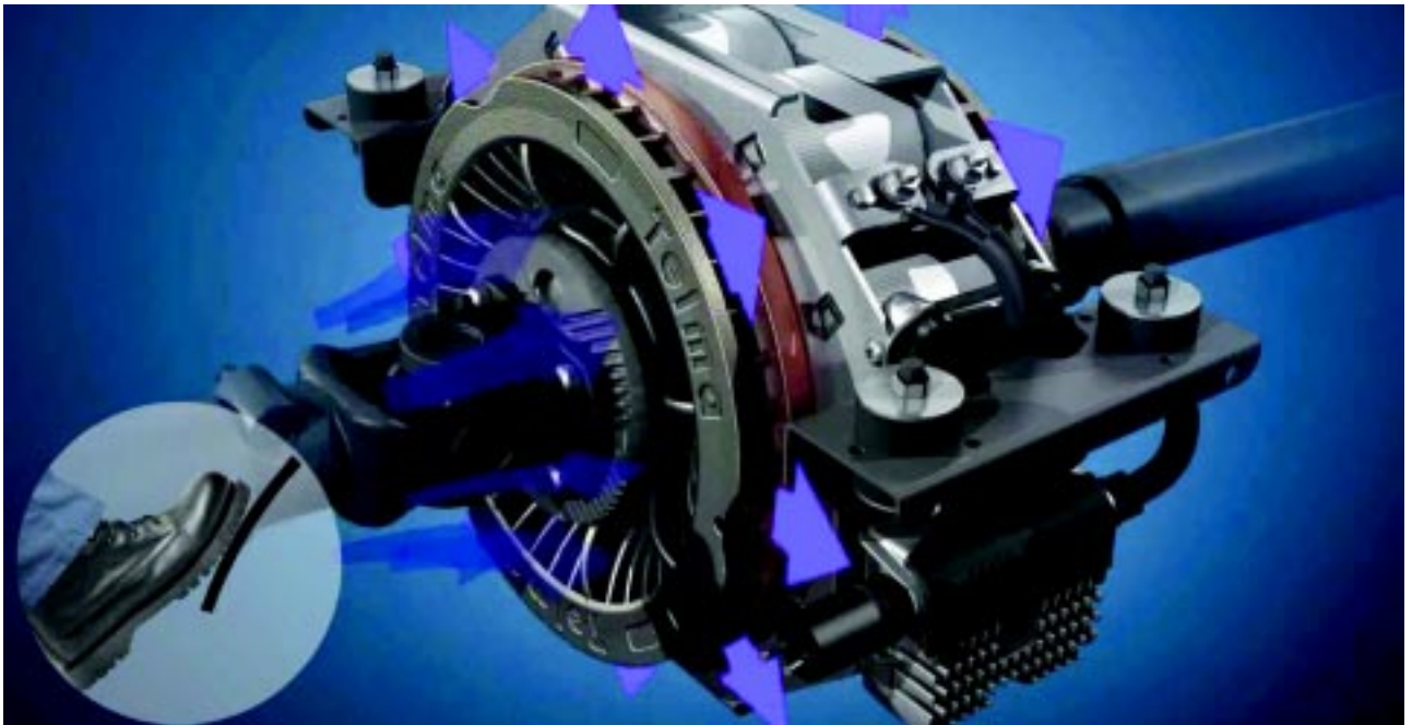
El freno Telma en funcionamiento. Las flechas azules indican la disipación del calor generado durante el funcionamiento.
